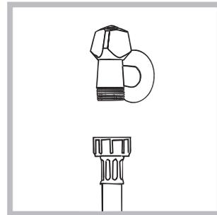
3. Проверьте, чтобы водопроводный шланг не был заломлен или сжат.
